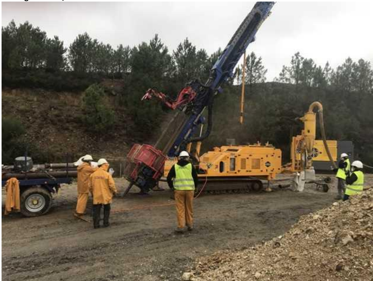
Figura 1: Sonda de Circulação Reversa da EDASU S.L. a perfurar o primeiro furo do programa de sondagens 2023/24
